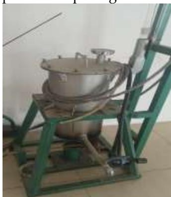
**Gambar 2.** Alat destiler minyak atsiri daun beluntas
