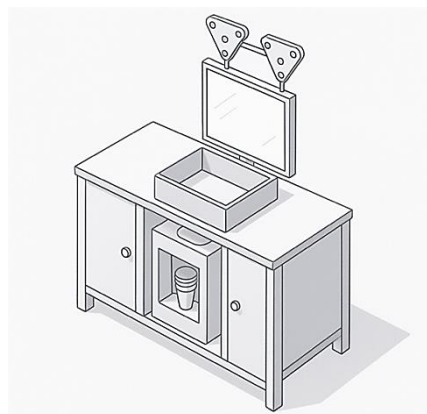
Gambar 2. Sketsa meja penyimpan mesin pengemas gelas.
