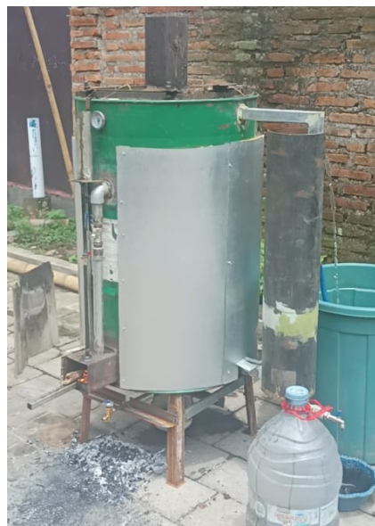
Gambar 1. Alat Pirolisis Berbasis Anaerob dan Kondensasi
